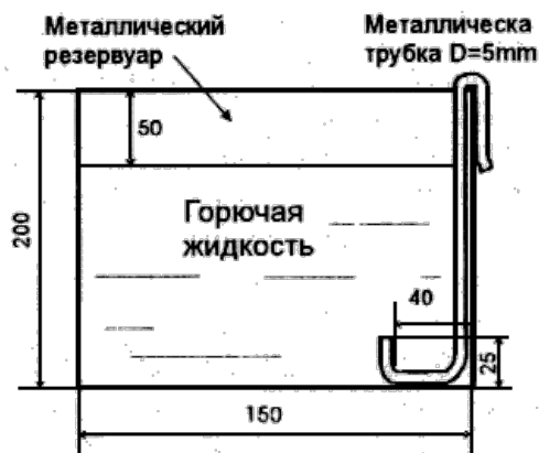
Рис.2. Основные размеры металлического резервуара для огневых лабораторных испытаний низкократной пены подслоиным способом
